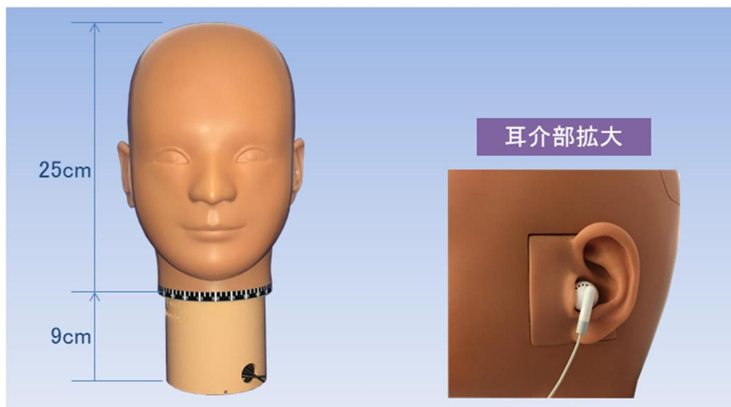
ダミーヘッドは人間の頭部、耳介を模したもので、耳介内部にマイクが内蔵されています。人間が使用するようにイヤホンやヘッドホンをセットすることで、簡単に周波数特性などを測定することができます。
